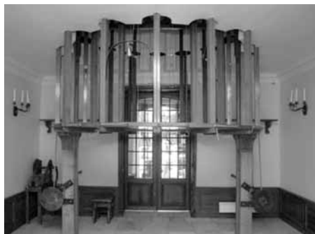
Механизм подъёмного стола в петергофском Эрмитаже. Современное фото.
